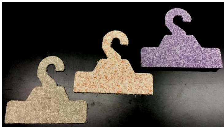
図4 「三河木綿CNF」を使用したハンガー試作品
